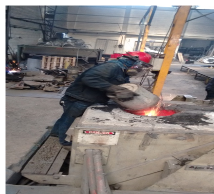
Ilustración 8. Reinserción de limalla al proceso de fundición
