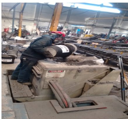
Ilustración 8. Reinserción de limalla al proceso de fundición
